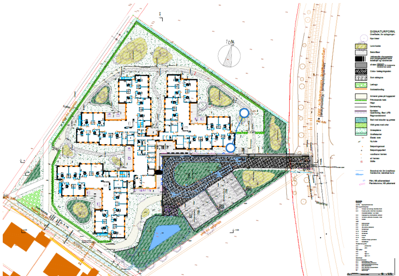
Figur 2: På figuren vises de arealer, der leder vand, til offentlig regnvandsledning via forsinkelsesbassin.
