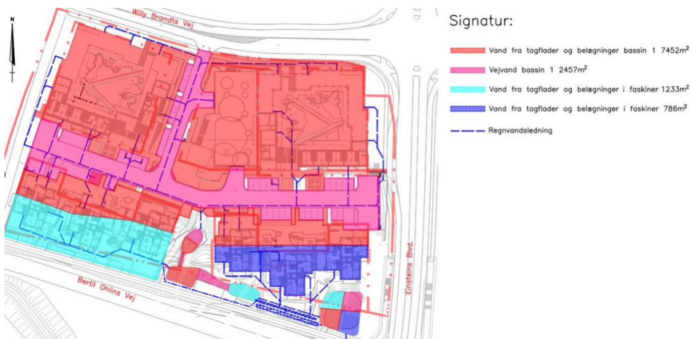
Fig. 7 Fordeling af arealer til regnbed og faskiner
