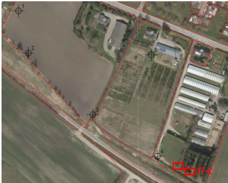
Figur 2: Placering for borer. Boring 2 er ikke udført. IT-1 og IT-2 er angivelse af infiltrationstest for nedsivningsbassin.
