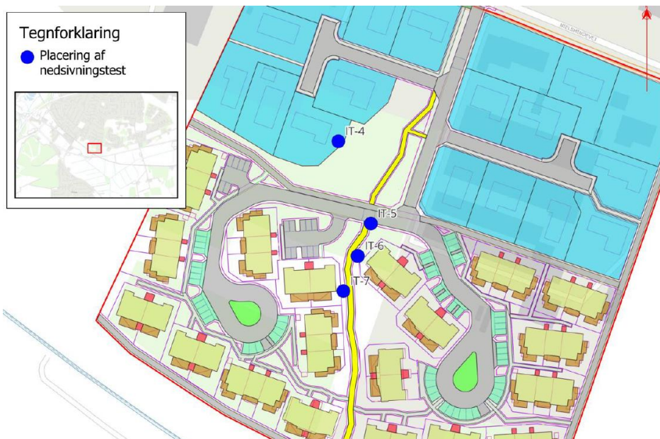
Figur 3: Udførte nedsivningstest for planlagt grøft i midten af projektområdet.
