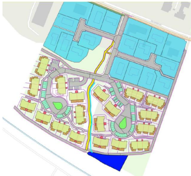
Figur 1: Situationsplan for regnvandshåndtering for byggemodning, Petuniaparken (matriklerne 2ch, 2h, 2g). Figuren angiver placering af nedsivningsbassin (blåt område) og grøft (grøn markering). De tre sydvestligste matrikler håndterer overfladevandet i faskiner. De lyseblå matrikler (nord) beregnes med en befæstelse på 40%, da der ikke foreligger plan for udstykningen og karakteriseres som åben-lav. Tabel 1 angiver befæstelsestypen for de angivne farver i figur 1.
