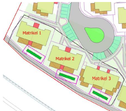
Figur 11: Angivelse af afstandskravet op 2 meter til bygninger og skel ved etablering af faskine på de tre sydligste matrikler.
