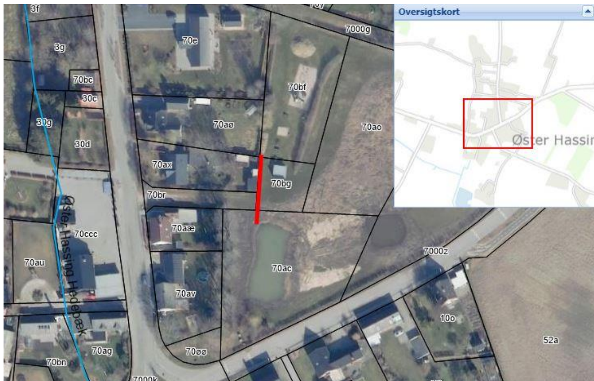
Figur 1: Placering af det nye rørlagte vandløb fra åben grøft mod nord til sandfangsbrønd ved sø er markeret med en rød linje. Øster Hassing Hedeback er markeret med en blå linje.
