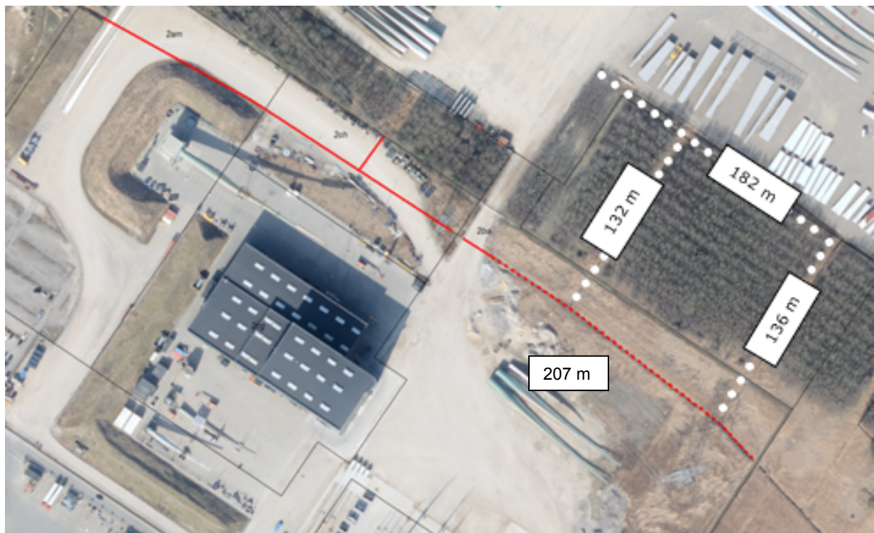
Figur 2 Oversigt over ansøgte rørlagte vandløb. Vandløbene er markeret med rød stiplede linje og hvid stiplede linje.
