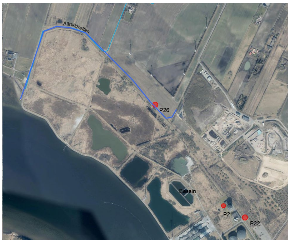
Figur 4. Oversigtskort der viser tre pumpebrønde og bassin hvor vandet fra de tre pumpebrønde ledes til. Den blå streg angiver det private vandløb, hvor drænvand, der ikke pumpes til bassin, ledes til. Det private vandløb løber til det offentlige vandløb Attrupgrøften og videre ud i Limfjorden.
