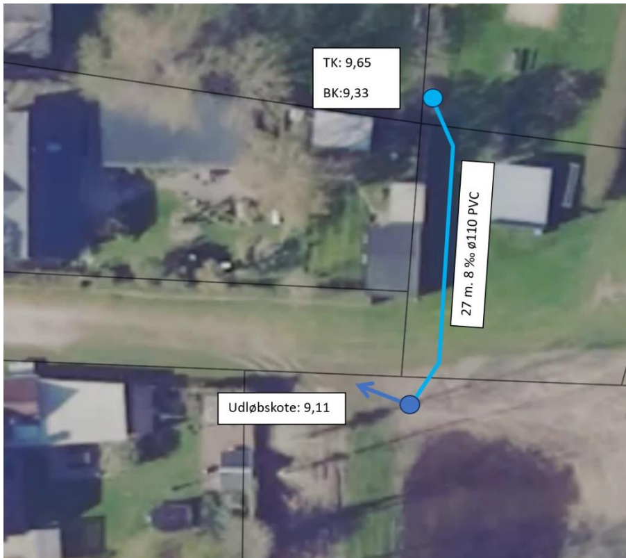
Figur 1: Placering af det nye rørlagte vandløb (blå linje) fra eksisterende åben grøft (lyseblå prik) mod nord til sandfangsbrønd (mørkeblå prik). Koter for anlægget er angivet på kortet.
